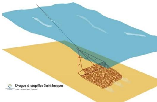
Tractée par un navire sur des fonds meubles ou caillouteux à l'aide d'une fûne manœuvrée par un treuil, la drague à coquilles Saint-Jacques est une sorte de râteau muni à l'arrière d'un sac en anneaux d'acier. Les dents positionnées sur l'ouverture permettent de ratisser les fonds et capturer les bivalves.
