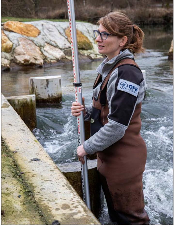
Récolement d'une passe à poissons avec la DDT, une opération visant à vérifier la fonctionnalité de l'ouvrage.
