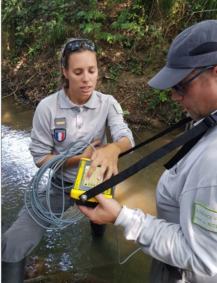
L'agent utilise un courantomètre dans un cours d'eau pour mesurer la vitesse d'écoulement de l'eau.
