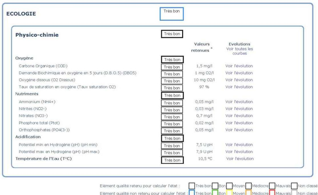
Figure 9 : Résultat des prélèvements effectués afin d'évaluer l'état du cours d'eau de l'Oriège au niveau des Forges d'Orlu (Source : Système d'information sur l'eau du Bassin Adour-Garonne, <http://adour-garonne.eaufrance.fr>).
