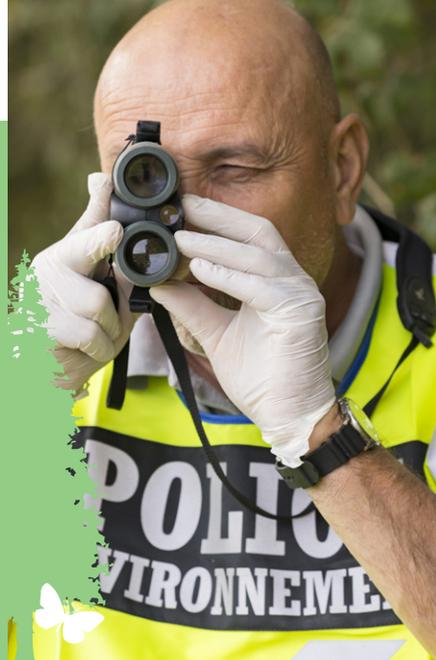
Un inspecteur de l'environnement prend une mesure de distance à l'aide d'un télémètre sur une enquête de terrain.
